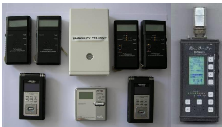
Photo 36: Détecteurs-amplificateurs d'ultrasons et enregistreurs numériques utilisés lors de l'étude
