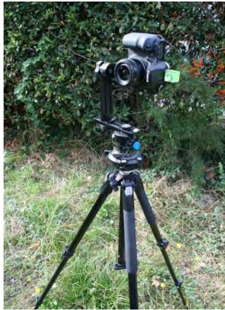
Figure 1 : dispositif d'acquisition d'images en séquence panoramique
