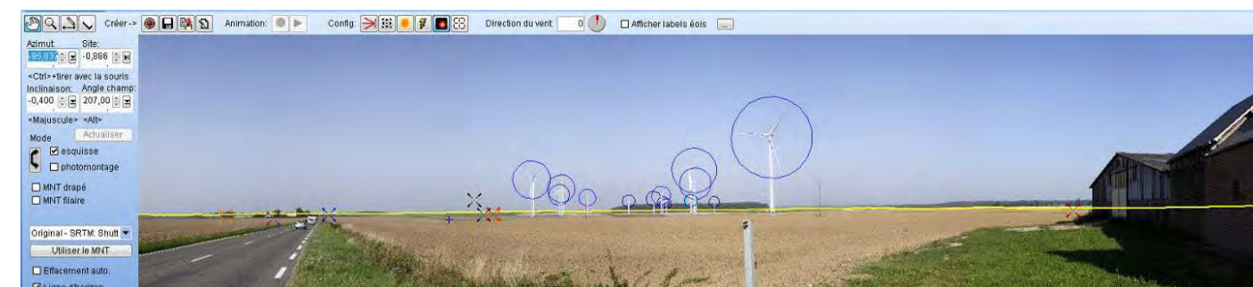
Figure 8 : principe de calage du panoramique sous WindPro
